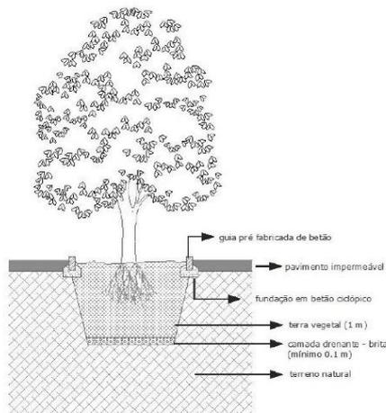
Figura 16 - Exemplo de plantação em zona pavimentada.
